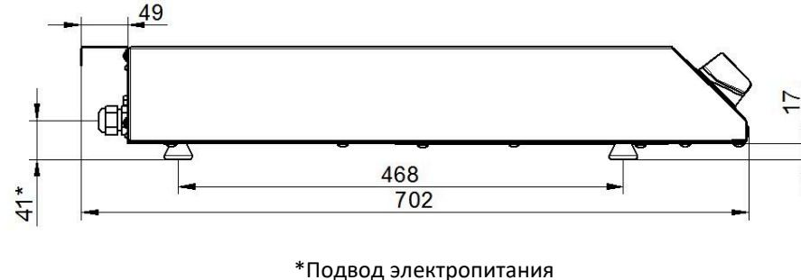
Плита индукционная кухонная настольная КИП-2Н предназначена для приготовления первых, вторых и третьих блюд в специальной наплитной посуде. Посуда должна быть с плоским дном, обладающая магнитными свойствами: посуда из нержавеющей стали или алюминия с ферромагнитным дном, чугунная посуда (посуда, к которой притягивается магнит).
